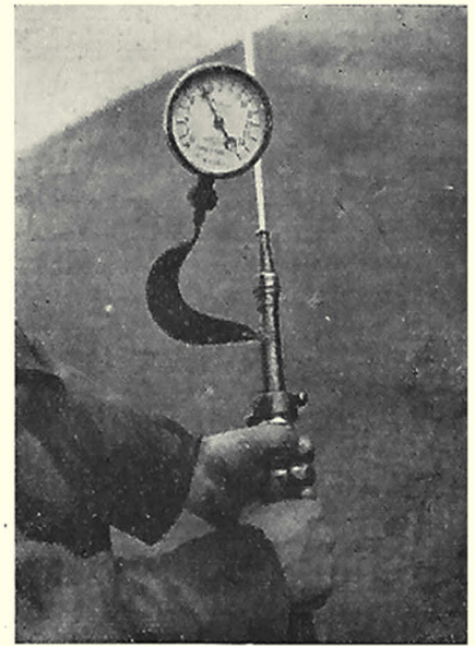
Prova di pressione al bocchello della pompa monocilindrica.
