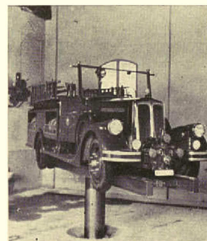
BOLOGNA - Sala di lavaggio e sollevatore idraulico.
