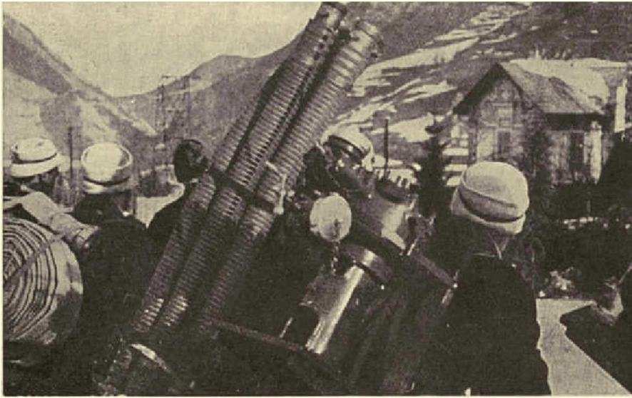
Corredi di aspirazione della motopompa.....
