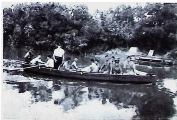
Prova della imbarcazione grande con carico normale (13 uomini)
